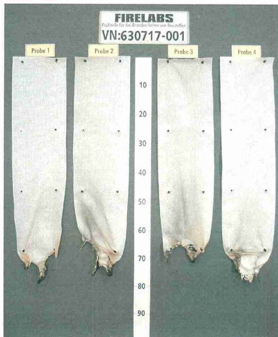
Bild 2 Aussehen des Probekörpers nach dem Brandversuch
