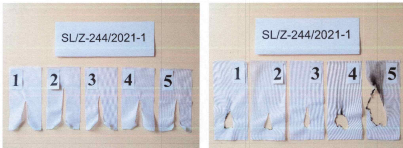
Rys. 5. Wygląd próbek po badaniu - ART: 101704/BC/WPL/OG (wzdłużny kierunek)
